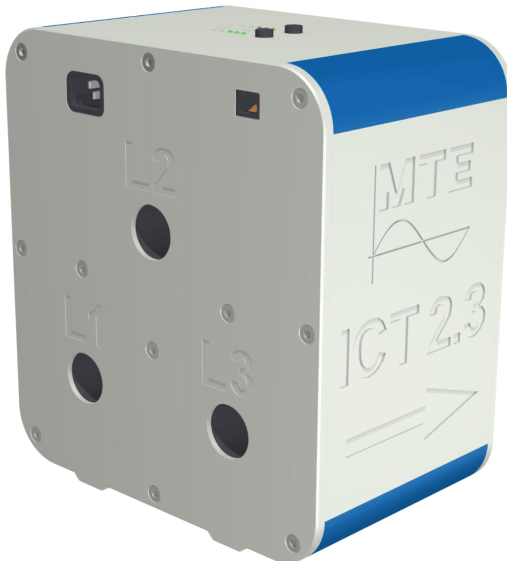
El transformador de aislamiento de corriente trifásico ICT 2.3 es utilizado en equipos de ensayo estacionarios, cuándo se deben de ensayar contadores trifásicos con la conexión cerrada entre el circuito de corriente y tensión (puentes de tensión). Cada vez se están produciendo e instalando más contadores de este tipo.
